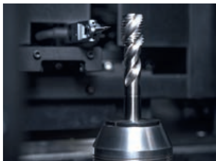
Fertig eingespannt – Bohrer und Fräser werden in der HELICHECK so mit Kameras und Tastern vermessen. Dabei werden Dutzende von Parametern bestimmt
