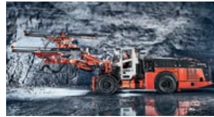
Der Sandvik DD422iE Development Jumbo ist vollständig emissionsfrei, während er zwischen den Abbaustrecken manövriert
