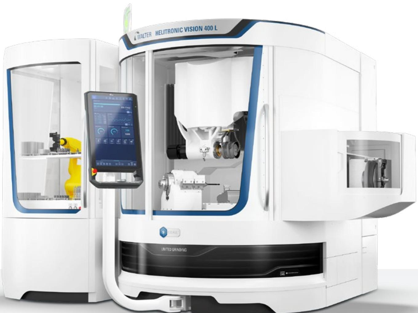
HELITRONIC VISION 400 L con las opciones Cambiador de Muelas (derecha) y cargador robotizado (izquierda)
